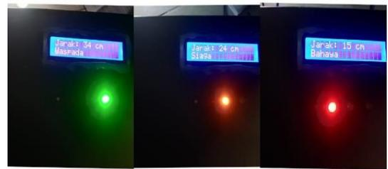
Gambar. 7 Data yang ditampilkan LCD pada Alat
