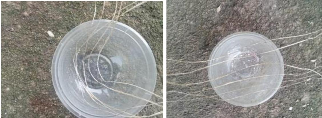
Gambar 1. Serat batang pisang yang dilapisi oleh  $\text{TiO}_2$
